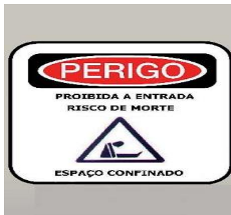
Figura 3- Sinalização para Identificação de Espaço Confinado. Fonte: Brasil, 2006.
