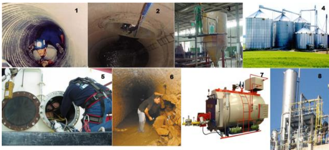
Figura 1 - Exemplos de espaços confinados: 1- Tubulação; 2- Rede de Esgoto; 3- Moega; 4- Silos; 5- Tanque de Armazenamento; 6- Galeria Subterrânea; 7- Caldeira; 8- Incinerador.
