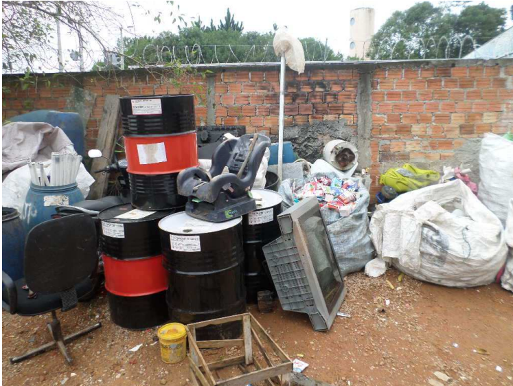
Figura 5 – Armazenamento de resíduos perigosos classe I (lâmpada fluorescentes e tonéis de óleo automotivos).Fonte: A autora (2016).
