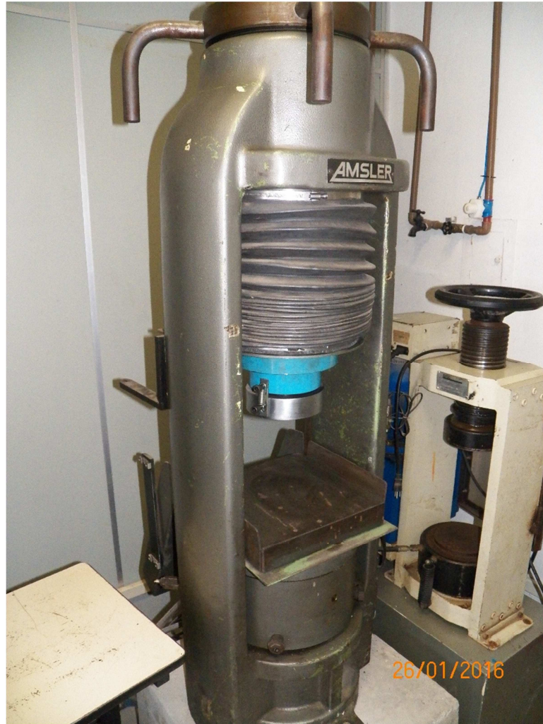
Figura 22– Ausência de sensores de parada de emergência visíveis e acessíveis aos operadores Fonte: O autor (2016)
