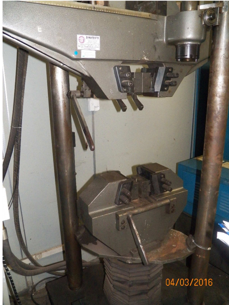
Figura 20– Ausência de proteções físicas nas partes móveis da máquina Fonte: O autor (2016)
