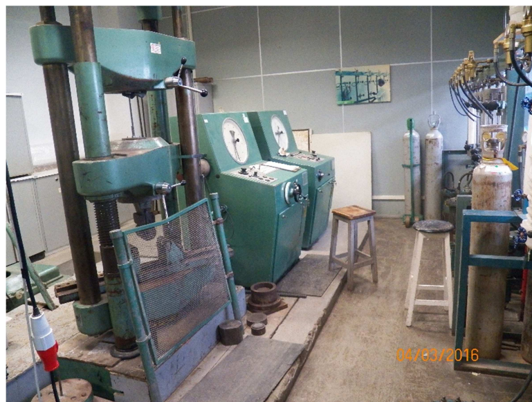
Figura 21– Uso de proteção móvel de forma inadequada Fonte: O autor (2016)
