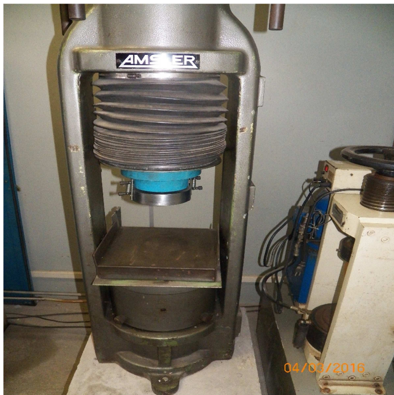
Figura 18– Vista frontal de uma máquina de ensaio de compressão mecânica Fonte: O autor (2016)
