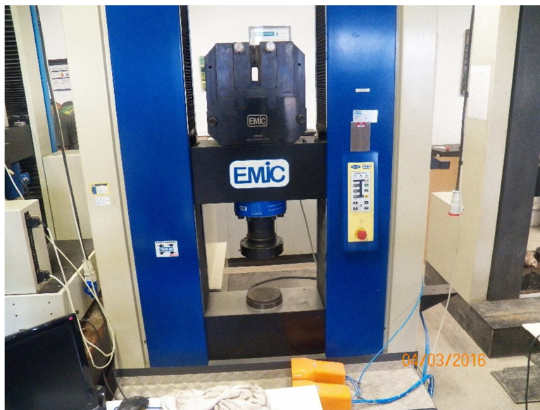
Figura 19– Ausência de proteções físicas nas partes móveis da máquina Fonte: O autor (2016)
