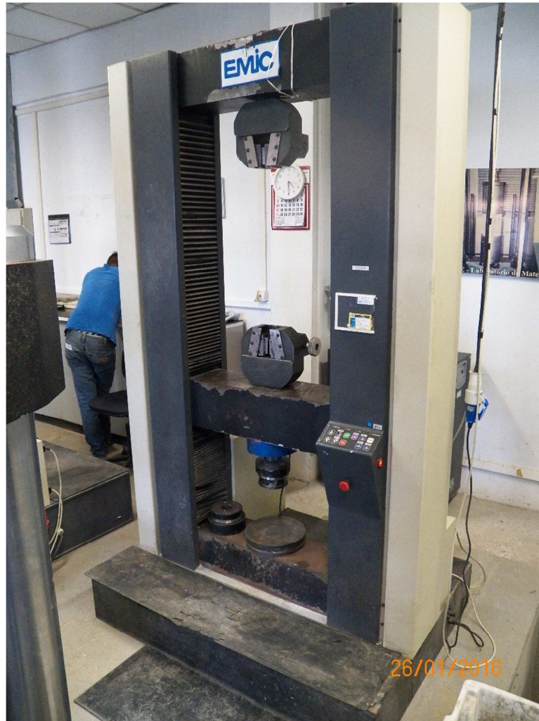
Figura 25– Máquina com projeto que desrespeita as exigências posturais Fonte: O autor 2016)
