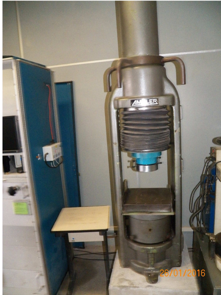
Figura 31– Ausência de cores de segurança nesta máquina Fonte: O autor (2016)
