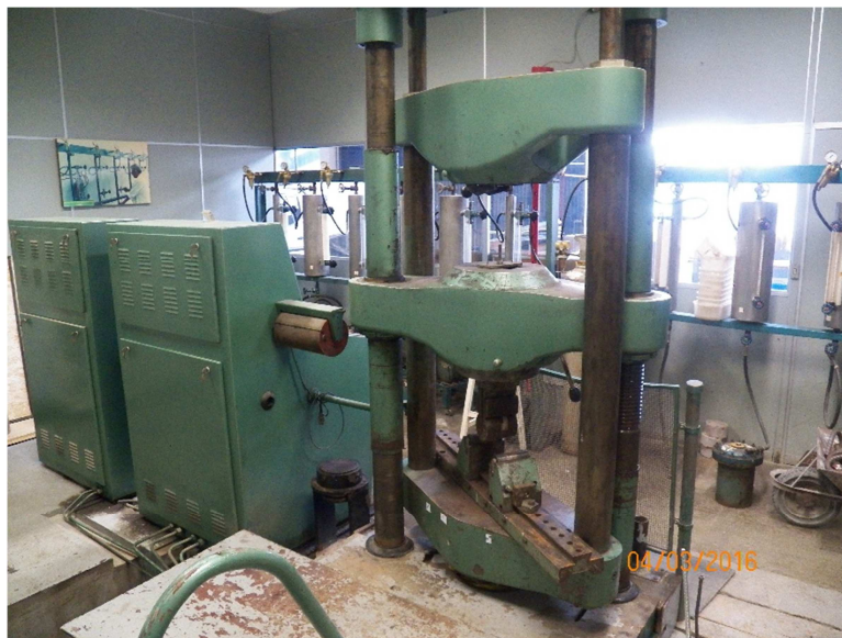
Figura 15– Máquina desprovida de um sistema de aterramento contra choques elétricos Fonte: O autor (2016)
