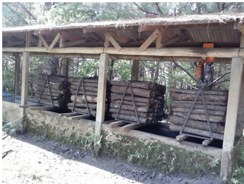
Fotografia 10 – Método para imersão das toras em água Fonte: Autoria própria.
