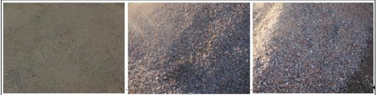
Conjunto de fotografias 1. Conjunto de fotografias dos Agregado de resíduos misto, primeira fotografia da esquerda para a direita: areia; pedrisco, brita 1
