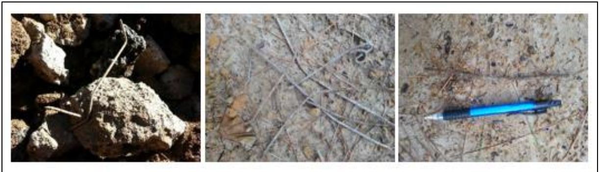
Conjunto de fotografias 27c. Material contaminante no agregado de resíduos do concreto. Ferros constituintes do concreto armado e plásticos. Comparativo ao objeto lapiseira de 15cm de comprimento.
