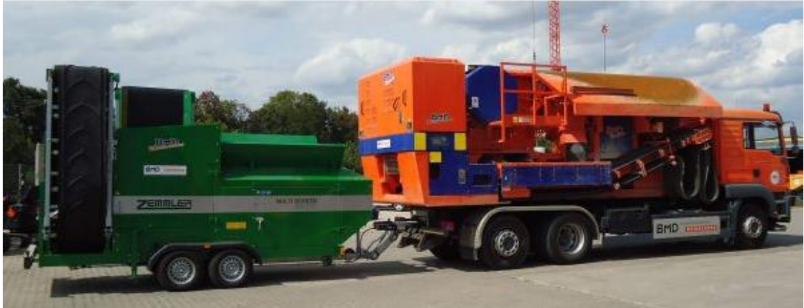
Fotografia 2. Imagem genérica de uma Usina Móvel de britagem dos RCD.
