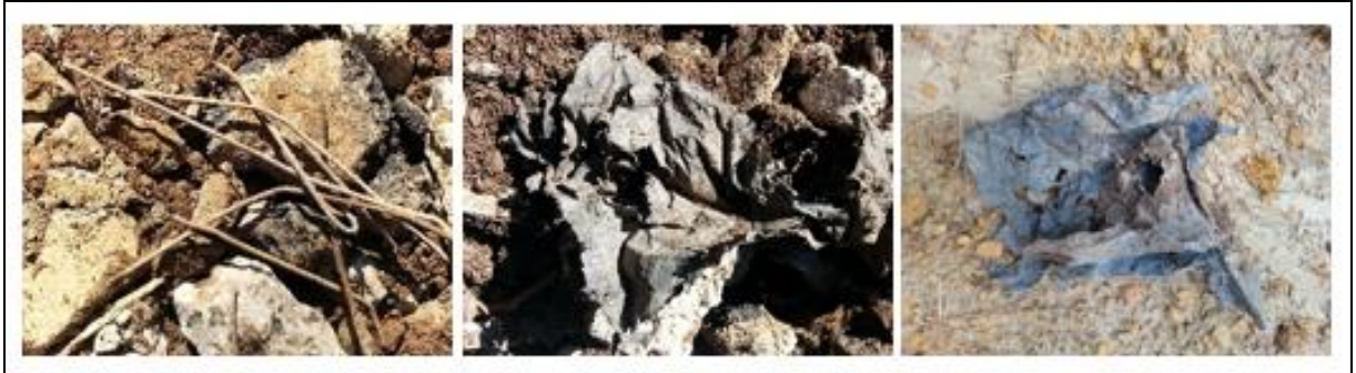
Conjunto de fotografias 27b. Material contaminante no agregado de resíduos do concreto. Ferros constituintes do concreto armado e plásticos.
