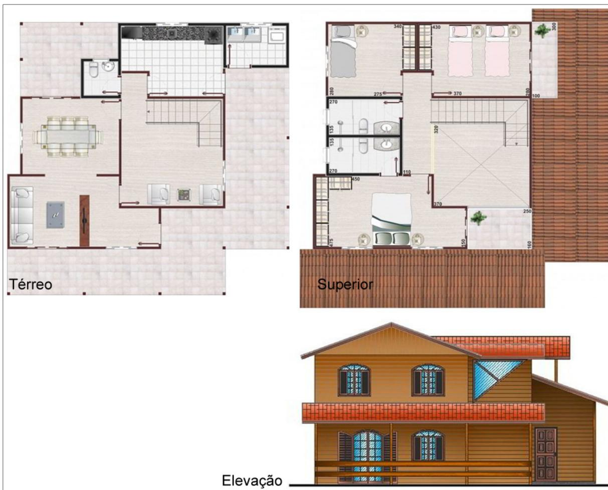
Figura 29 - Exemplo de projeto padrão no sistema "Parede dupla" com 185,90 m<sup>2</sup>
