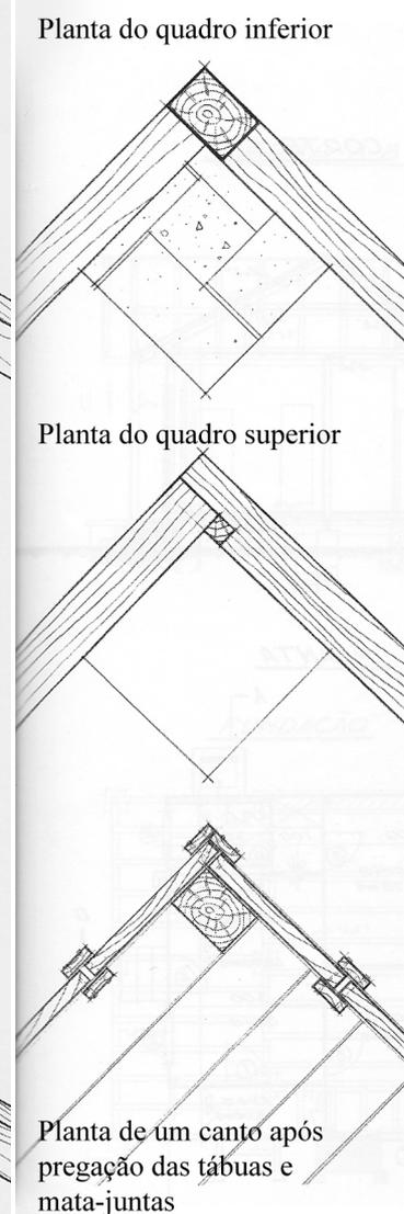
**Figura 15 – Ligações do esteio com os quadros inferior e superior**
