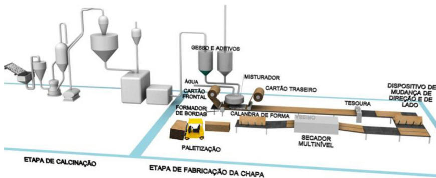
Figura 12: Processo de produção das chapas de gesso acartonado.
