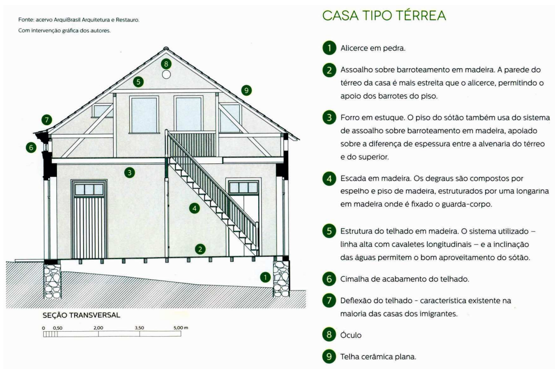
Figura 11. Elementos construtivos – casa tipo 2
