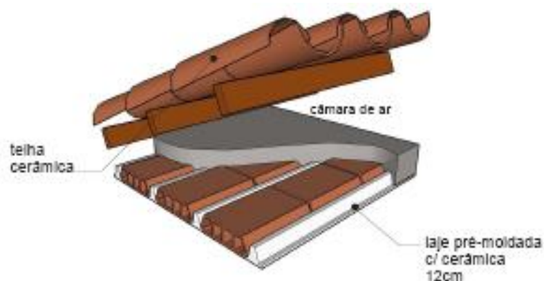
FIGURA 20 – CARACTERÍSTICAS DA COBERTURA COM TELHA DE CERÂMICA E LAJE Fonte: LabEEE, 2010.
