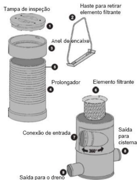
Figura 21: Peças do filtro Vortex WWF 100. Fonte: CATÁLOGO TECNICO ACQUASTOCK apud BRAGA, 2009, p 106.
