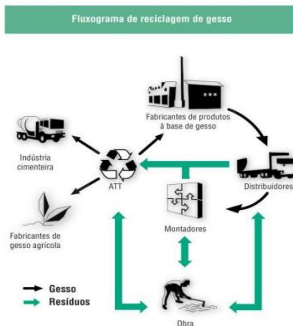
**Figura 01 – Fluxograma do processo de reciclagem de gesso**
