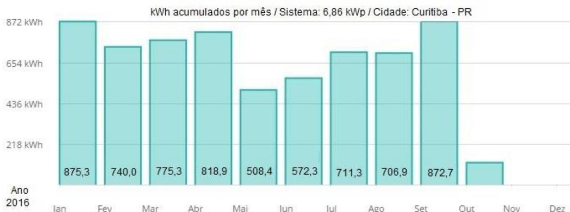
Figura 25 – Geração de energia em SFVCR de 6,86 kWp operante na cidade de Curitiba (PR).
