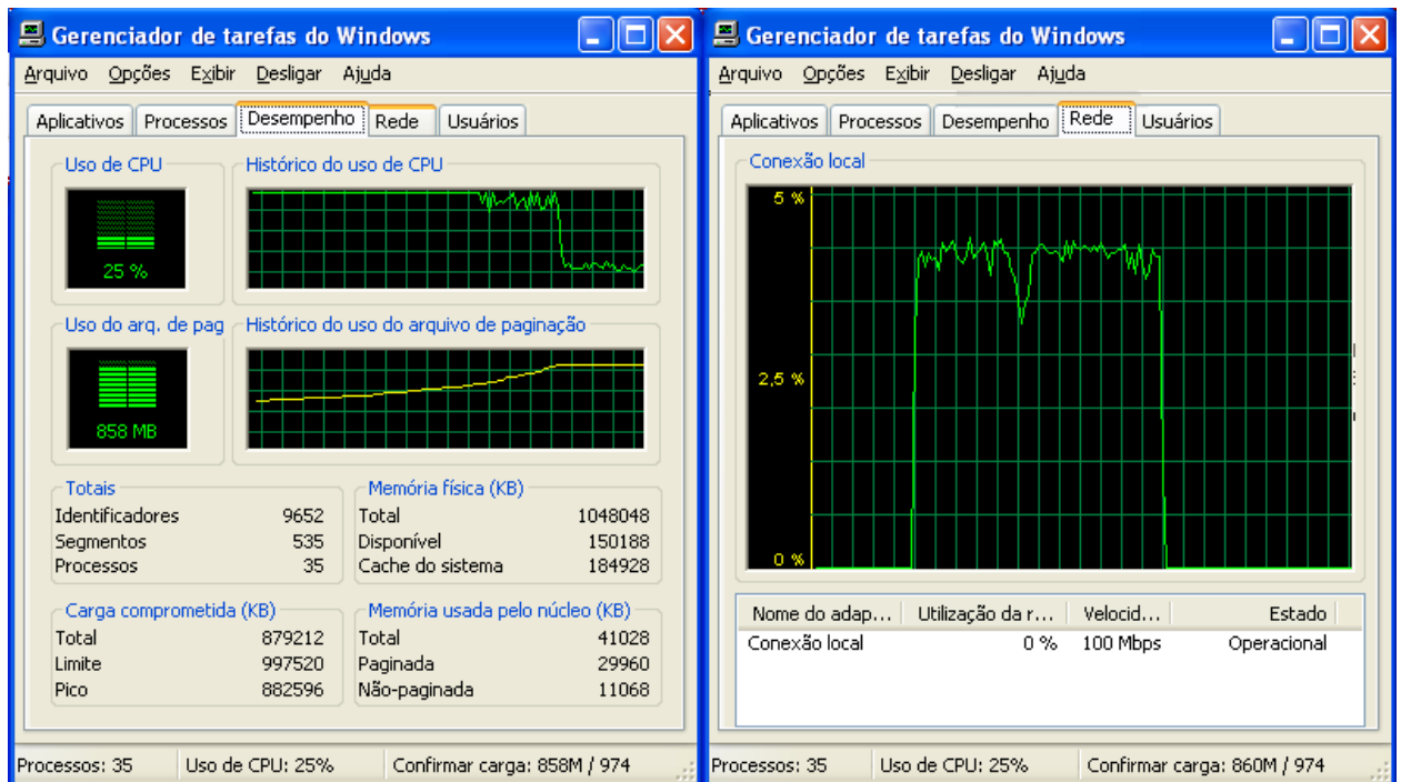
Figura 30 – Monitor do uso da CPU e da interface de rede durante um ataque Inundação SYN
