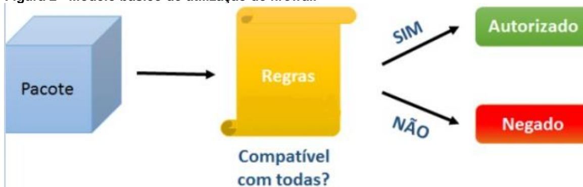
Figura 2 - Modelo básico de utilização de firewall
