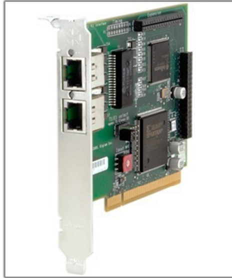
Figura 36: Placa de telefonia digital Digium™ modelo Te205 Dual Fonte: DIGIUM, 2013
