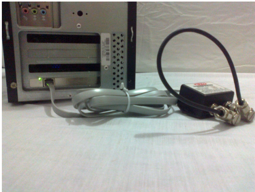
Figura 43: Teste de loop na placa Sangoma A101 Fonte: Autoria própria
