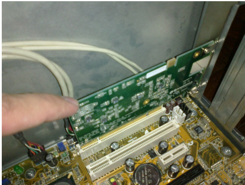
Figura 40: Instalação da placa Sangoma™ A101 em um slot PCI Fonte: Autoria própria
