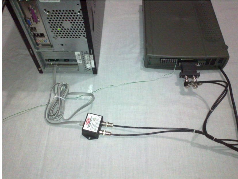
Figura 44: Ligação entre a placa E1 do servidor Asterisk e o modem da operadora Fonte: Autoria própria
