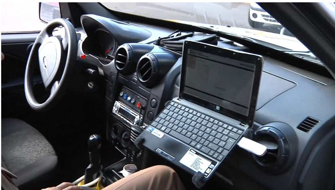
Figura 30 – Foto do Netbook instalado na viatura com modem 3G. Fonte: autoria própria
