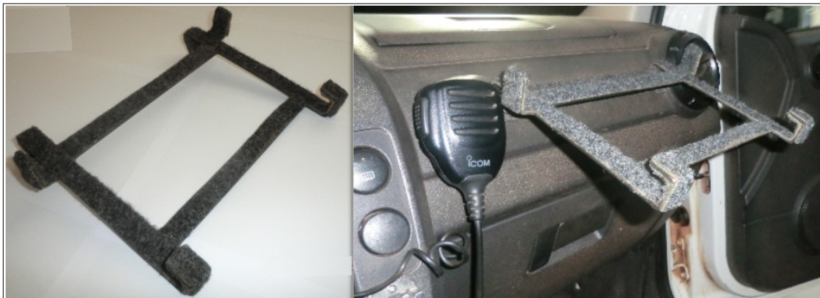
Figura 29 – Fotos do suporte instalado. Fonte: autoria própria
