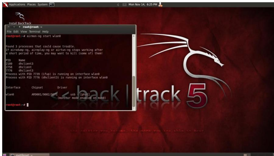
Figura 18 - Ativar modo monitor na placa de rede sem fio
