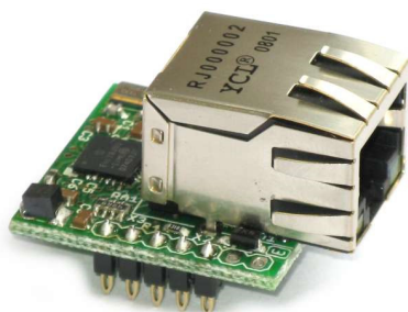
Figura 25 - Módulo PoE Fonte: raspberrypi.stackexchange.com .
