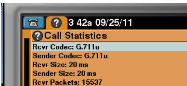
Figura 11 - CODEC G.711 em funcionamento
