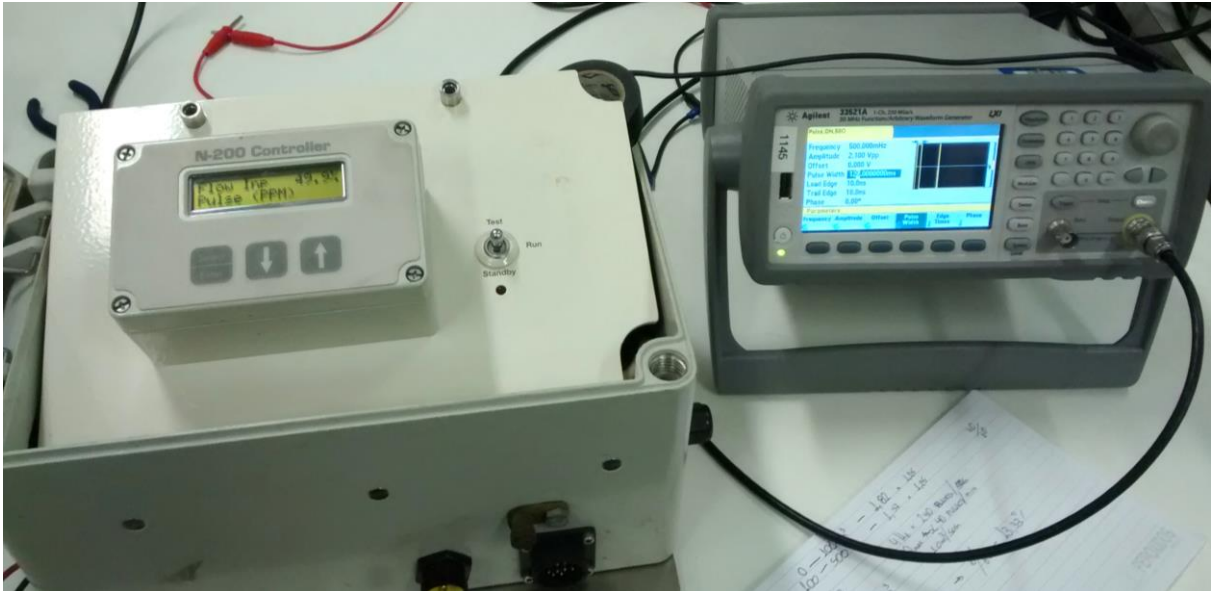
Figura 14 – Resposta do controlador N-200 ao sinal aplicado. Fonte: Autoria própria
