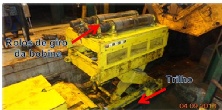
Figura 6: Acionamento dos rolos de giro.
