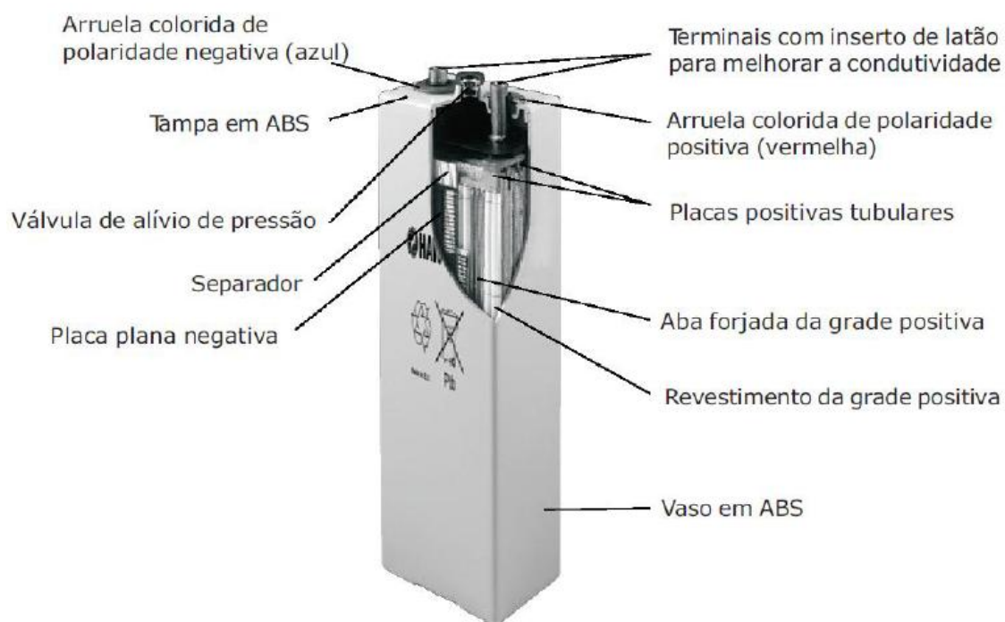
Figura 12 – Partes componentes de uma bateria regulada por válvula Fonte: Enersys, 2012
