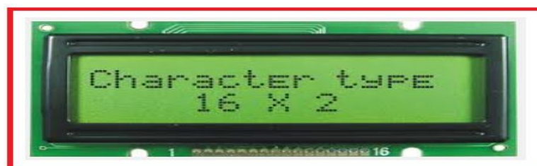
Figura 6 – Display LCD 16x2 a caracter. Fonte: Autoria própria.
