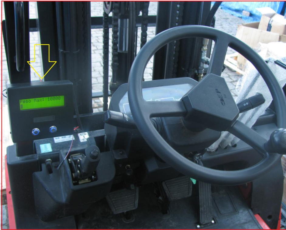
Figura 25 – Montagem da central eletrônica da balança na empilhadeira. Fonte: Autoria própria.
