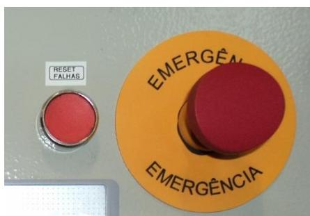
**Figura 75 – Botão de emergência e botão de reset**
