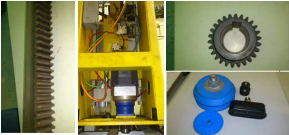
Figuras 15- Componentes do manipulador (cremalheira, engrenagem, ventosa e servo motor).
