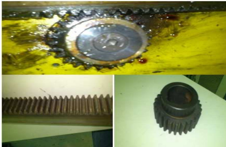
Figura 18 -. Estrutura do encaixe da engrenagem e a cremalheira.
