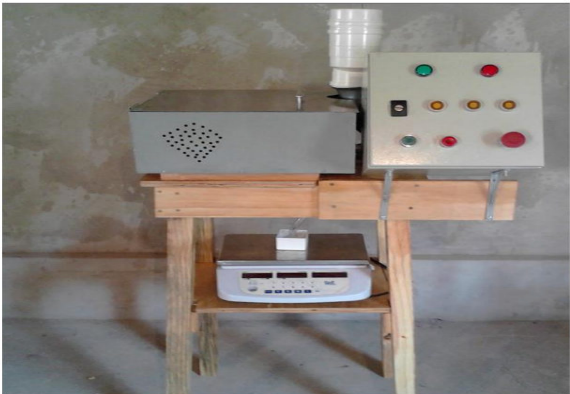
Figura 32 – Fotografia do Triturador montado. Fonte: O Autor
