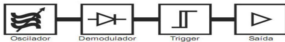
Figura 14 - Diagrama de blocos do sensor de proximidade indutivo. Fonte: SENSE, sensores
