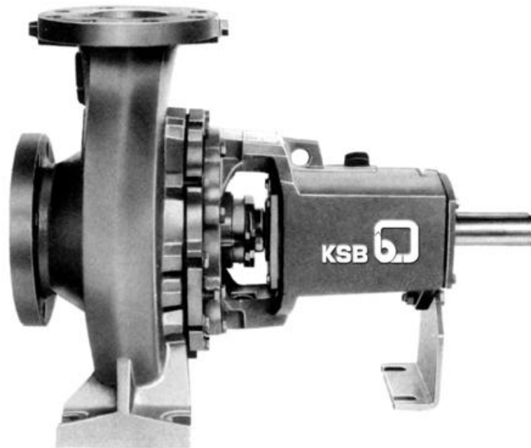
Figura 2.7 - Bomba centrífuga horizontal, estágio único, de sucção simples. Fonte: KSB (2009).
