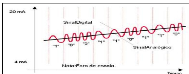
Figura 16: Sobreposição do sinal digital FSK ao sinal analógico de 4 a 20 mA. Fonte: Borges (2009).
