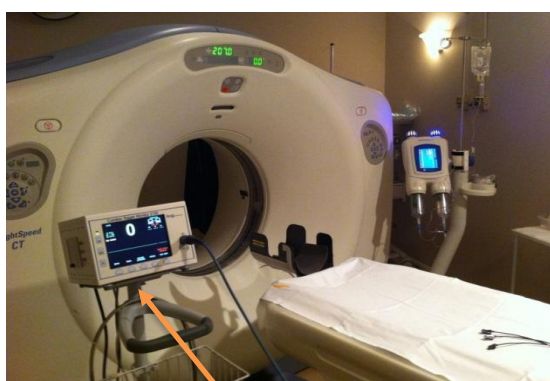
Figura 25: Monitor Cardiac Triger 3150 Fonte: Autor, 2014.
