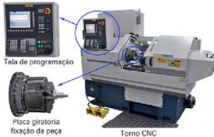
**Figura 13** - Exemplo de uma máquina CNC.
