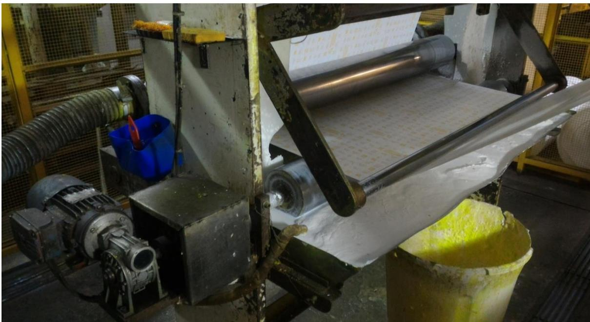
Figura 3 - Fotografia do conjunto aplicador de resina.
