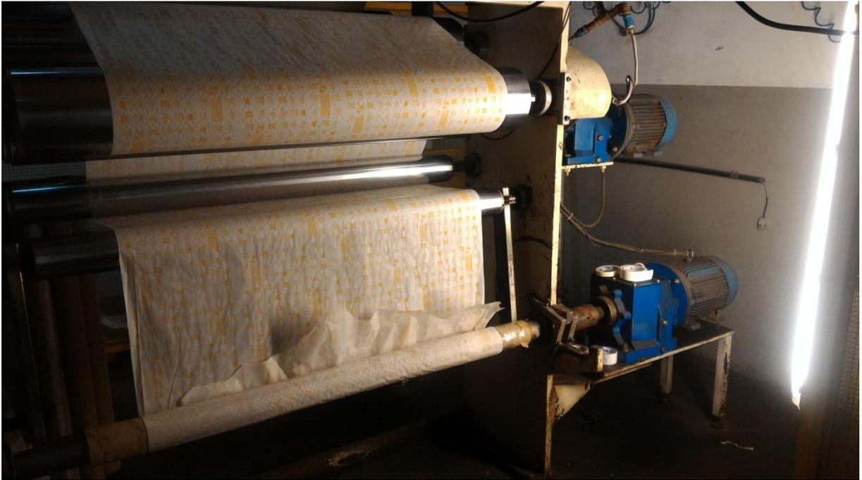
Figura 5 - Fotografia do conjunto do rebobinador.
