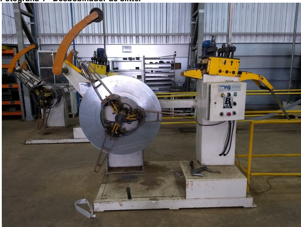
Fotografia 1 - Desbobinador de slitter
