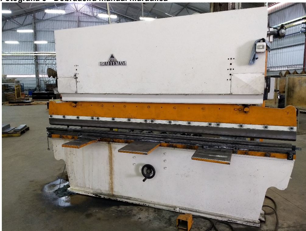
Fotografia 3 - Dobradeira manual hidráulica
