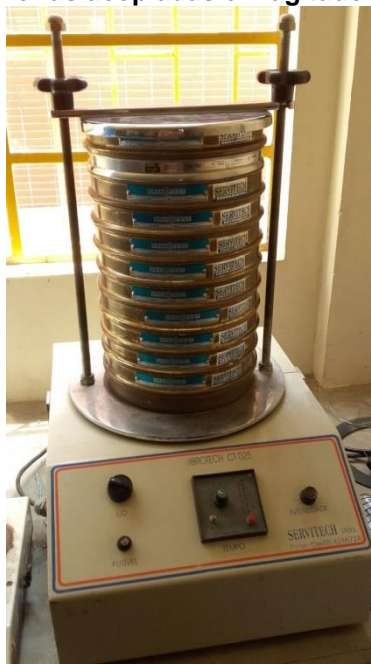
Fotografia 1 – Peneiras acopladas em agitador Vibrotech CT025.
