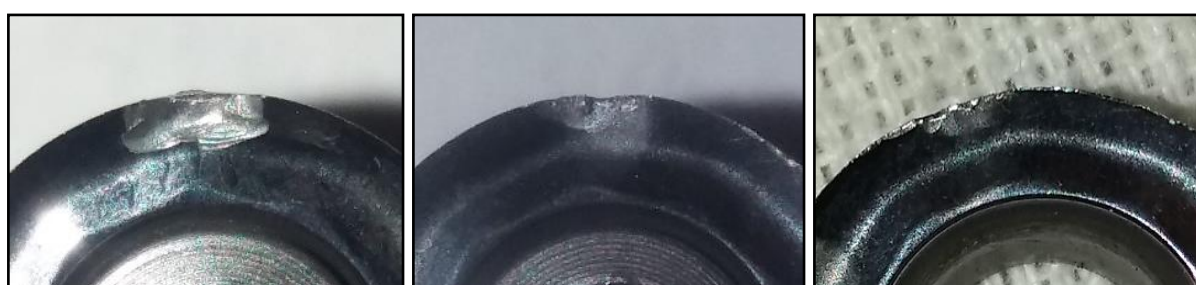
a) b) c) Figura 21 - Desgaste do primeiro inserto, variando a velocidade de avanço: a) 20 mm/min, b) 30 mm/min e c) 40 mm/min.
