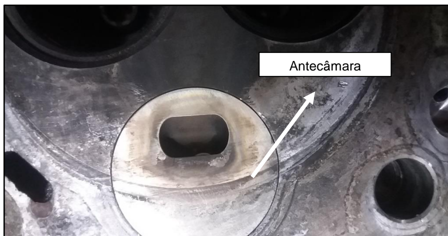
Figura 20 - Antecâmara do cabeçote. Fonte: O autor.
