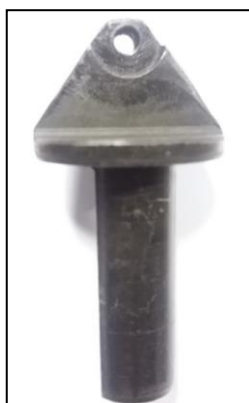
Figura 16 - Suporte para insertos intercambiáveis. Fonte: O autor.
