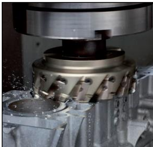
Figura 9 - Exemplo de faceamento no processo fresamento. Fonte: Direct Industry (2017b).
