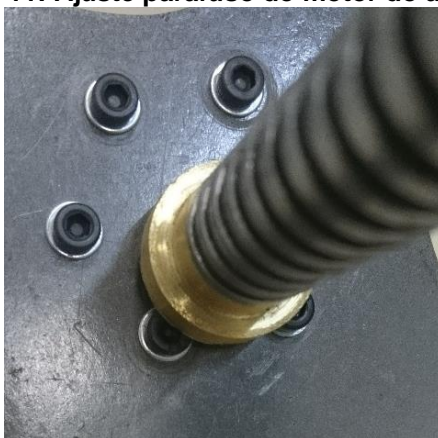
Figura 11: Ajuste parafuso do motor do atuador.
