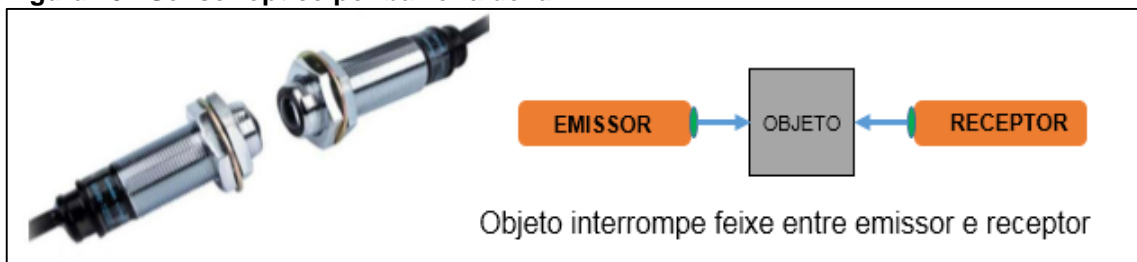
Figura 20 - Sensor óptico por barreira de luz
