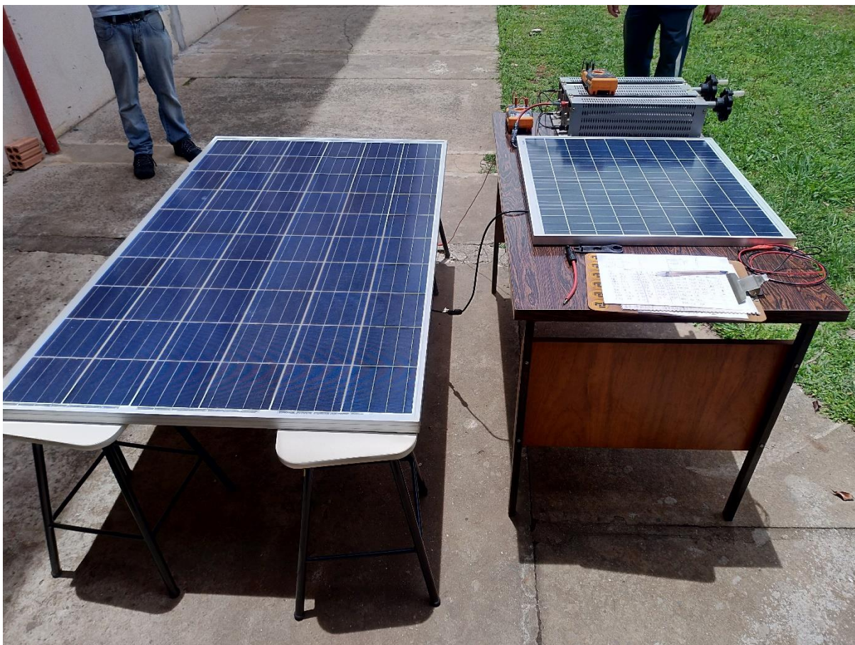
Figura 31 - Bancada para experimentação de módulos de 55W e 260W ligados em série.
