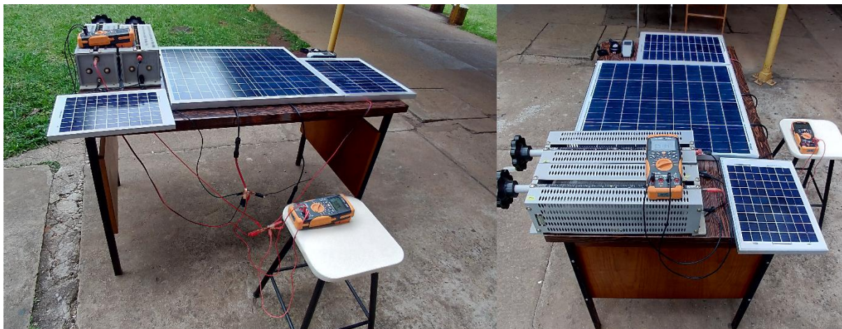
Figura 25 - Bancada para experimentação de módulos de 10W, 20W e 55W conectados em série e paralelo.
