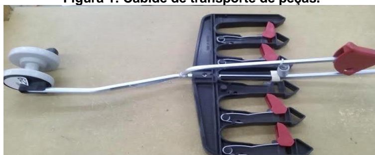
Figura 1: Cabide de transporte de peças.
