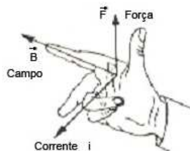
Figura 12: Relação entre Corrente, Campo e Força.
