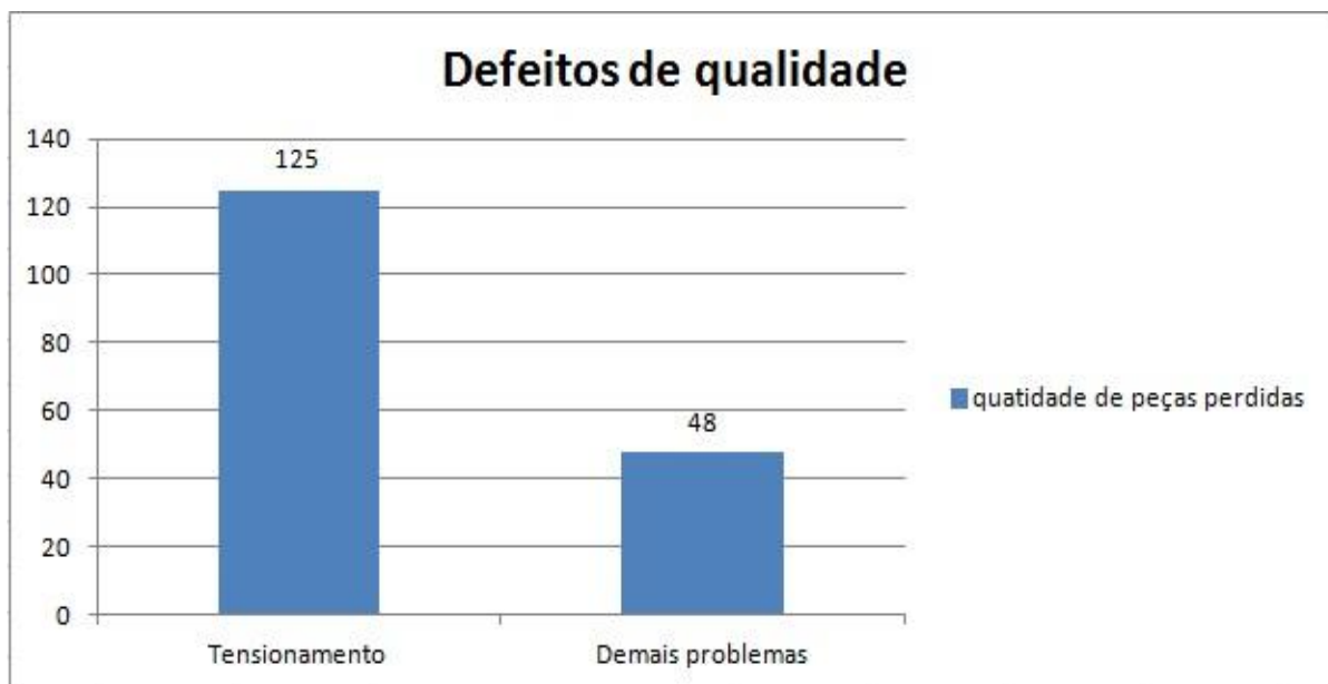
Gráfico 3 - Peças perdidas devido ao tensionamento e aos demais problemas Fonte: Autoria própria
