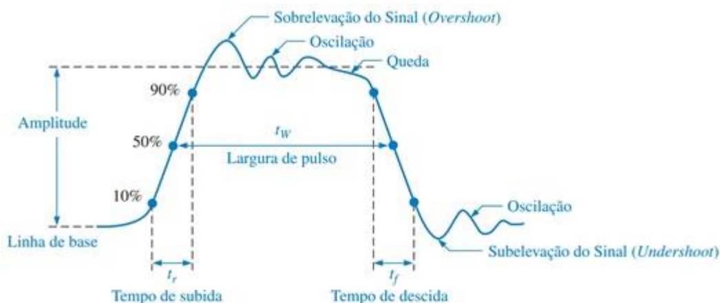
Figura 12 Demonstração da coleta dos tempos de subida e descida de um pulso.
