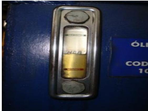
**Figura 4: Visor de nível de um reservatório**
