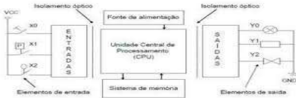
Figura 12: Estrutura de um CLP
