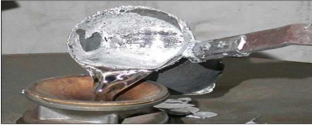
Figura 6: Dosagem manual de alumínio
