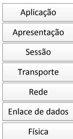
Figura 1 - Camadas modelo OSI Fonte: Autoria própria
