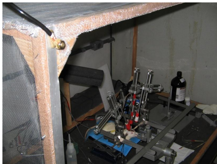
Figura 29 - Gaiola de Faraday construída para realização dos procedimentos estereotáxicos e de medições de concentração de neurotransmissores in vitro e in vivo – no detalhe a conexão de cabo de aterramento que segue à área externa para ligação às hastes tipo cooperweld.
