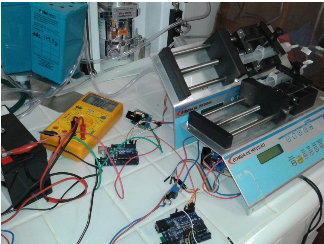
Figura 31 - MCU 3 e MCU 4 com reguladores de tensão e drivers de potência para acionamento das bombas de infusão.
