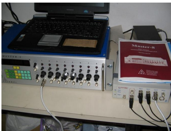
Figura 26 - Estimulador de bancada AMPI e sistema de aquisição de dados eDAQ.
