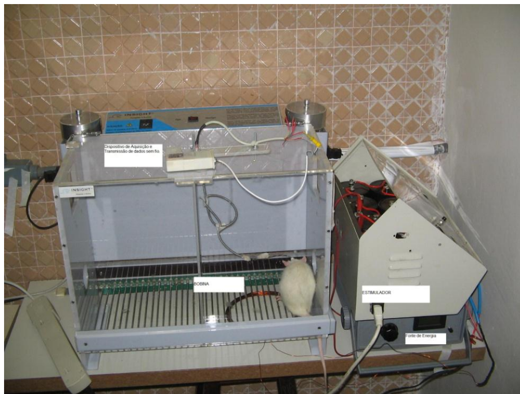
Figura 24 - Estimador TMS aplicando pulsos em rato em caixa de esquila com a realização de FSCV simultaneamente.
