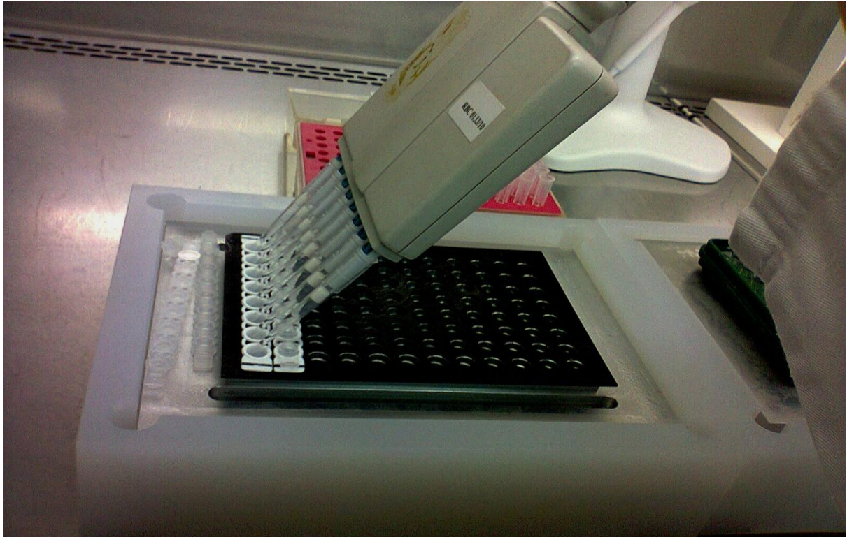
Figura 11- Pipetou-se 50 \mu l dos tubos de reação lise, para o tablete de PCR.
