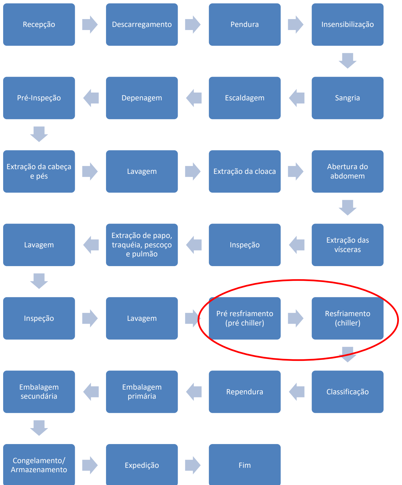
Figura 1: Fluxograma do processo de produção de frango inteiro Fonte: Autoria própria
