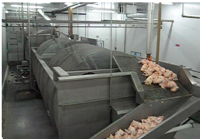
Figura 5: Modelo de chiller industrial do tipo rosca sem fim Fonte: Frigomaq
