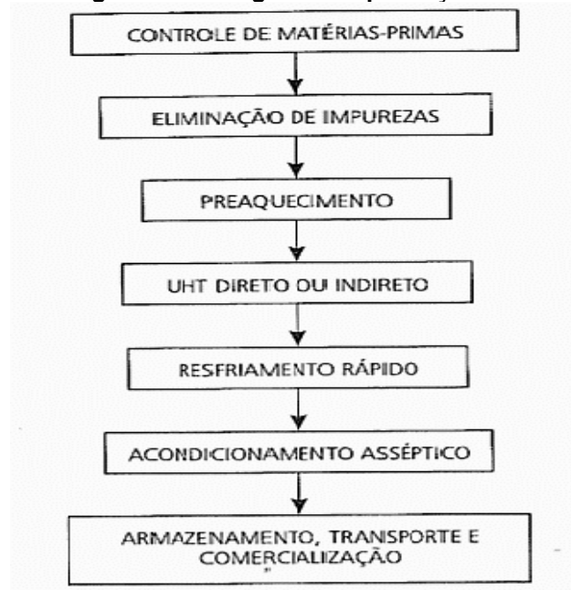
Figura 1 - Fluxograma de produção do leite UHT
