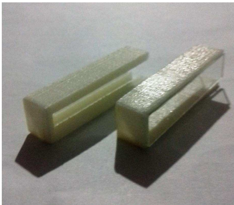
Figura 22 – Diferença entre protótipo tratado e não tratado com acetona
