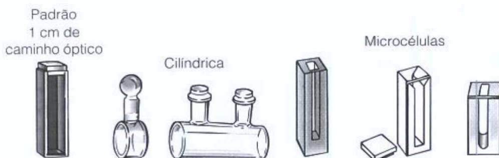
Figura 6 - Tipos comuns de cubeta para medidas nas regiões UV/VIS
