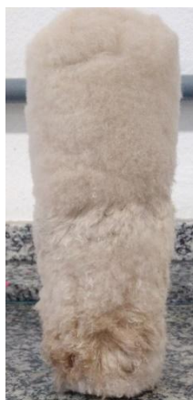
Figura 30: Rolo de lã após teste de submersão em água
